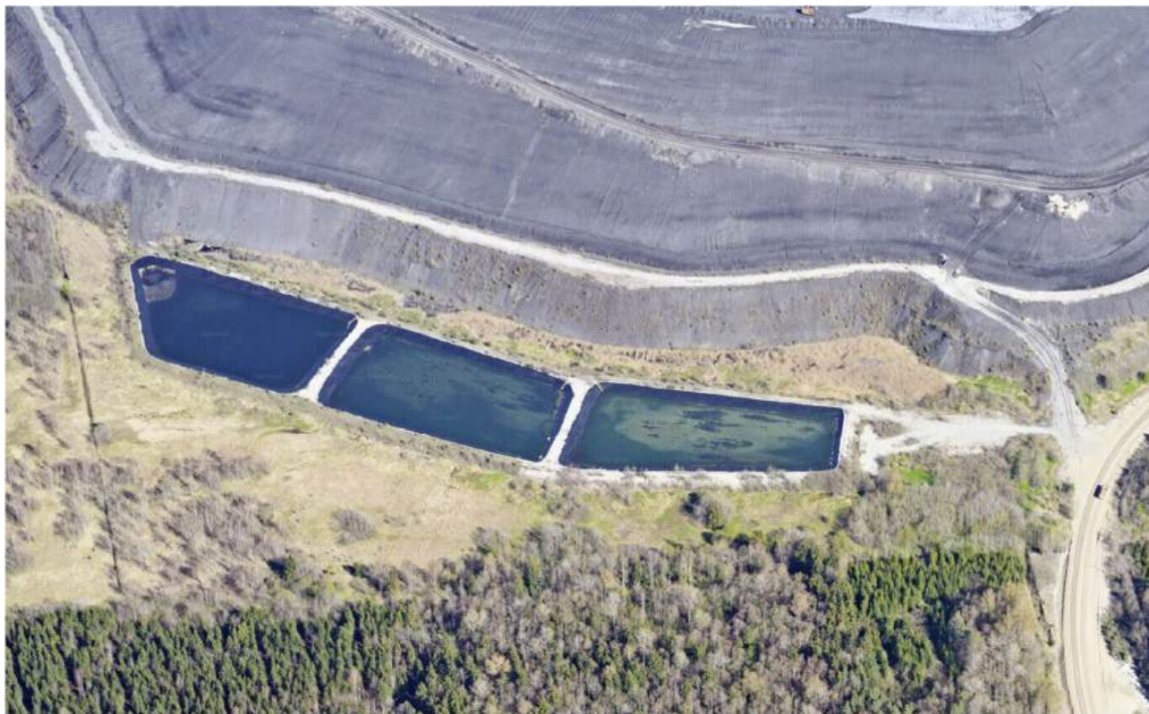
Joonis 6. Prügila lääneküljel paiknevad valg- ja nõrgvee ühtlustustiigid (Maa-ameti kaldaaerofoto, pildistamise aeg 06.05.2023).
